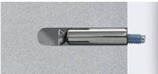
3. Reinigen Sie das Loch und setzen Sie die Schraube ein
