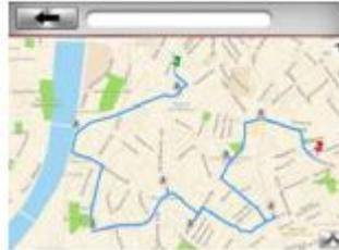
Geben Sie zuerst Start und Ziel ein. Danach klicken Sie auf die Punkte, durch die Sie die Trasse führen wollen (maximal können 8 Punkte eingestellt werden). Das System plant die Lauftrasse nach der aktuellen Einstellung.
