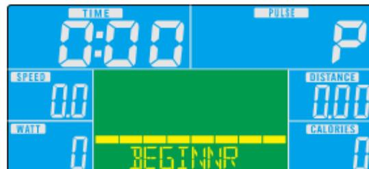
1. Mit Hilfe der Tasten UP und DOWN wählen Sie das Programm Beginnrr aus und zum Eintritt drücken Sie die Taste MODE.
