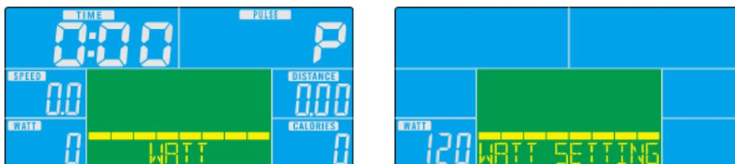
1. Mit Hilfe der Tasten UP und DOWN wählen Sie das Programm WATT aus und zum Eintritt drücken Sie die Taste MODE.
