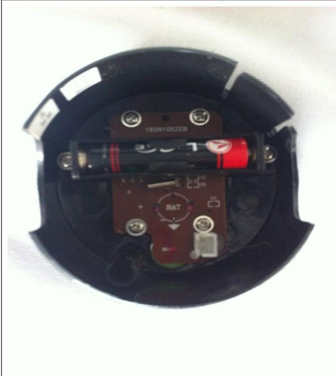
Öffnen Sie das Fach des Computers (22) und führen Sie die Installation der Batterie durch.
