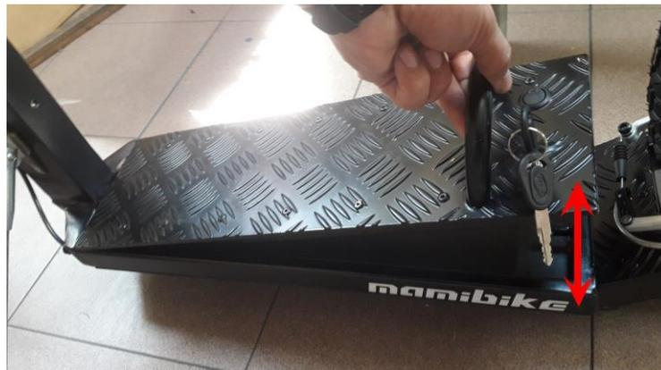
**Ausnehmen der Batterie nach dem öffnen des Batterieverschlusses**
