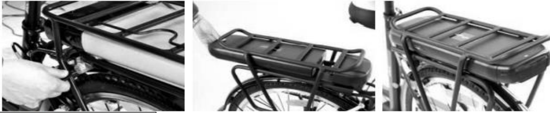
Entfernung der Batterie
