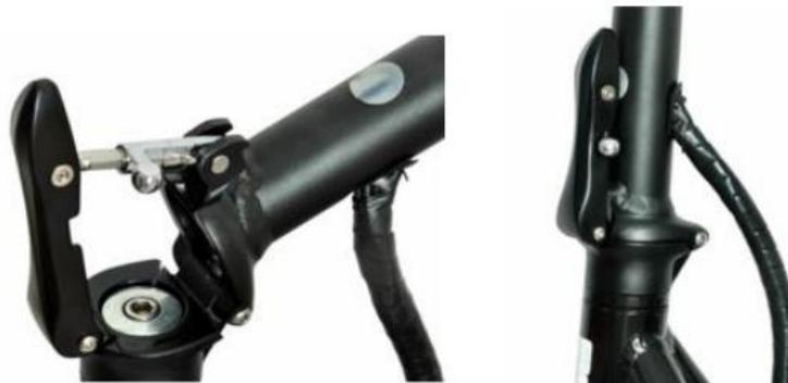
3. Verwenden Sie den Schnellverschluss in der Mitte des Lenkers, um die passende Position des Lenkers einzustellen.
