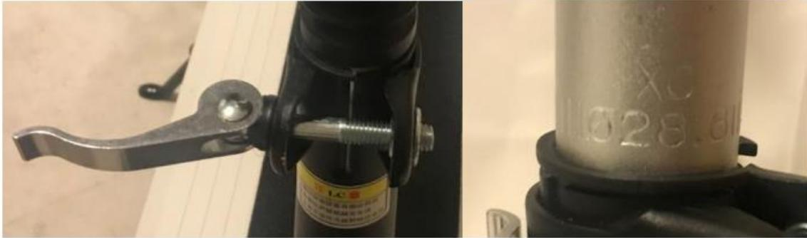
7. Heben Sie den Sitz an und sichern Sie ihn mit dem Hebel. Zum Absenken des Sitzes den Hebel drücken und den Sitz absenken.
