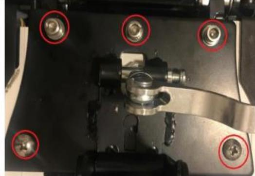
3. 3x Innensechskantschrauben festziehen, 2x Kreuzschlitzschrauben unter dem Blinker mit Muttern befestigen.
