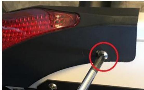
5. Drücken Sie den Stift an der Seite der Halterung zusammen, heben Sie den Sitz an und sichern Sie ihn mit dem Stift und dem Schnellspannhebel.
