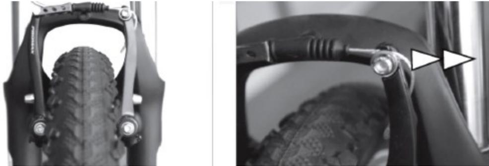
Die richtige Bremsenfunktion ist erst dann gesichert, wenn nach dem Druck die ganze Lamellenoberfläche in dem Kontakt mit der Felge ist und wenn die Bremsenlamellen mit der Felge in einer Linie zusammenlaufen. Nachdem der Hebel gelöst gewesen ist, soll die Distanz zwischen der Felge und Bremsenlamellen auf beiden Seiten die gleiche sein. Man muss regelmäßig die Abnutzung kontrollieren. Es befinden dort die Rillen für die bessere Abnutzungskontrolle.
