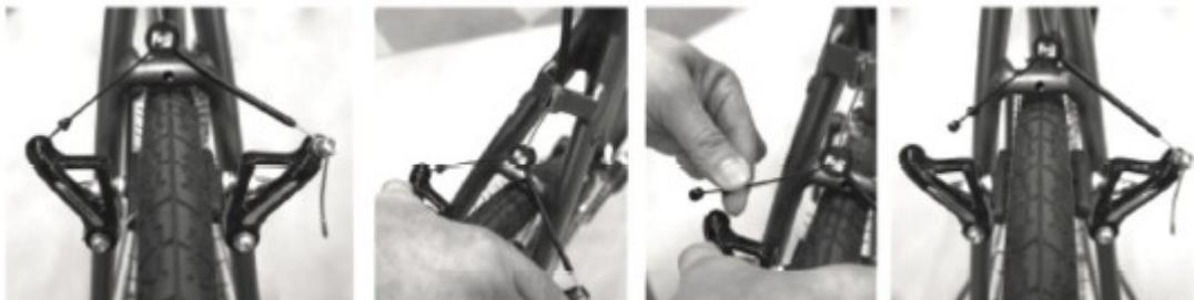
Bei den Caliper-Bremsen lösen Sie das Bremsseil mit dem Backenhebel.
