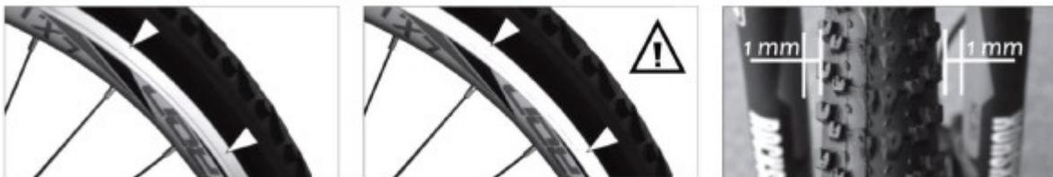
Es sollten keine Rillen oder Ritzen auf der Radfläche sein. Machen Sie eine Prüfung. Betasten Sie die Bremsfläche mit einem Nagel. Wenn Sie die Unebenheiten entdecken, fragen Sie den Verkäufer.
