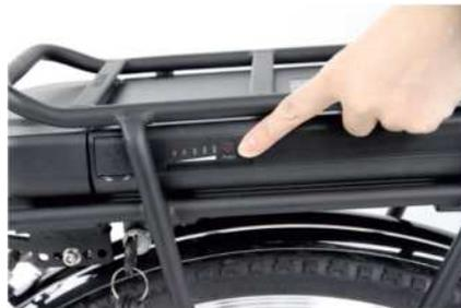
Die Batterie ist voll aufgeladen, wenn alle Leuchten auf der Skala zur Anzeige der Aufladung der Batterie leuchten.
