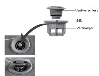
Zum Öffnen des Ventils zum Zweck des Ablassens der Luft drücken Sie den Mittelstift und drehen Sie damit im Uhrzeigersinn, bis seine Sicherung einsinkt.
