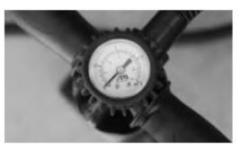
3. Schalten Sie den Druckschlauch in den Druckmesser bis zum Anschlag ein.
