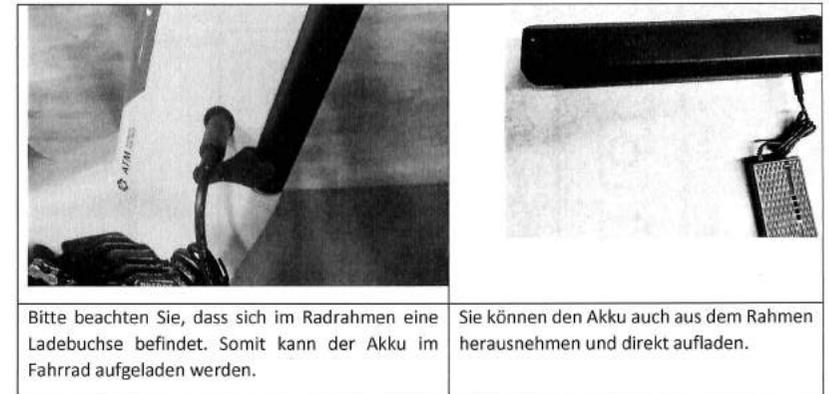
Bitte beachten Sie, dass sich im Radrahmen eine Ladebuchse befindet. Somit kann der Akku im Fahrrad aufgeladen werden.
