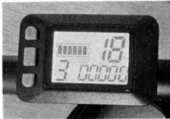
6.1.1. Anzeige am Display: Anzeige von Geschwindigkeit, Leistung, Panne, Gesamtzahl der zurückgelegten Kilometer und Anzahl der pro Fahrt zurückgelegten Kilometer.
